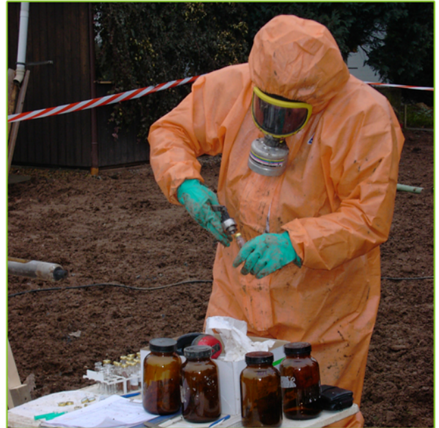
Bodenprobenahme auf kontaminiertem Standort
