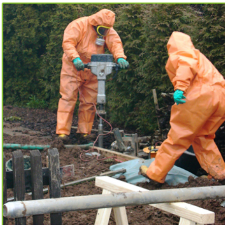
Rammkernsondierung auf belastetem Standort
